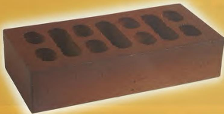
Absorción: 3,5% - Succión: 0,03(g/cm<sup>2</sup> min.) - Resistencia compresión: 500(daN/cm<sup>2</sup>) - Expansión por humedad: 0,10(mm/m) - No eflorescido - No heladizo
