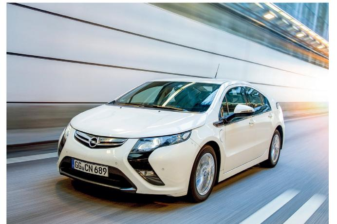
El Opel Ampera-e lograba la cuadratura del círculo, uniendo una autonomía eléctrica de entre 55 Km y 60 Km, suficiente para cubrir la gran mayoría de los trayectos diarios con un motor gasolina que actúa como generador si el marcador de kilómetros restantes llega a cero. Recurre a las mismas tecnologías que los actuales modelos híbridos enchufables, como el Opel Astra PHEV, pero dando todo el protagonismo a la propulsión “cero emisiones”.
