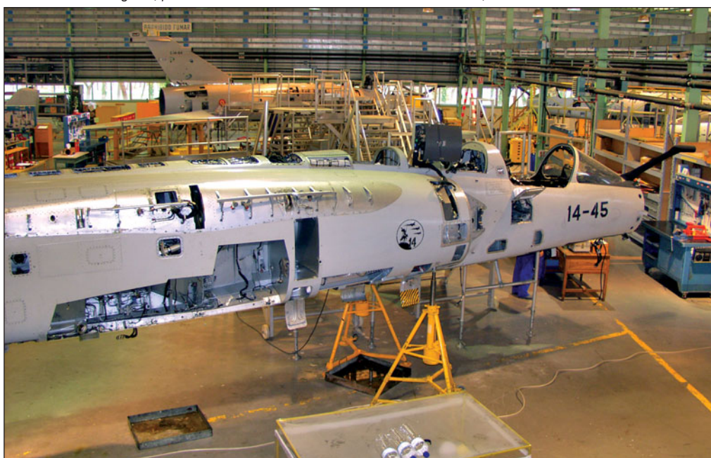
Revisión de un Mirage F1, procedente del Ala 14 de la Base Aérea de Los Llanos, en la Maestranza Aérea de Albacete.
