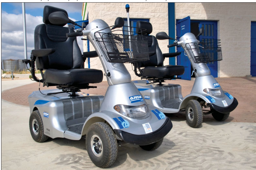
Vehículos scooter propulsados por pilas de combustible fabricados por la empresa albaceteña AJUSA.
