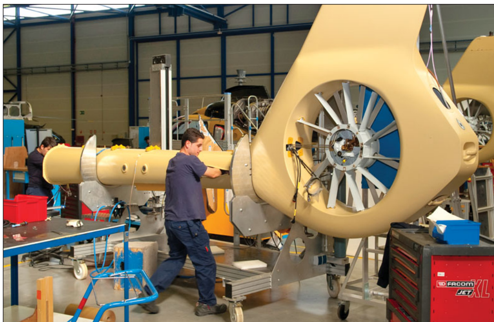
Montaje de un helicóptero EC-135 en la fábrica que Eurocopter mantiene en Albacete.
