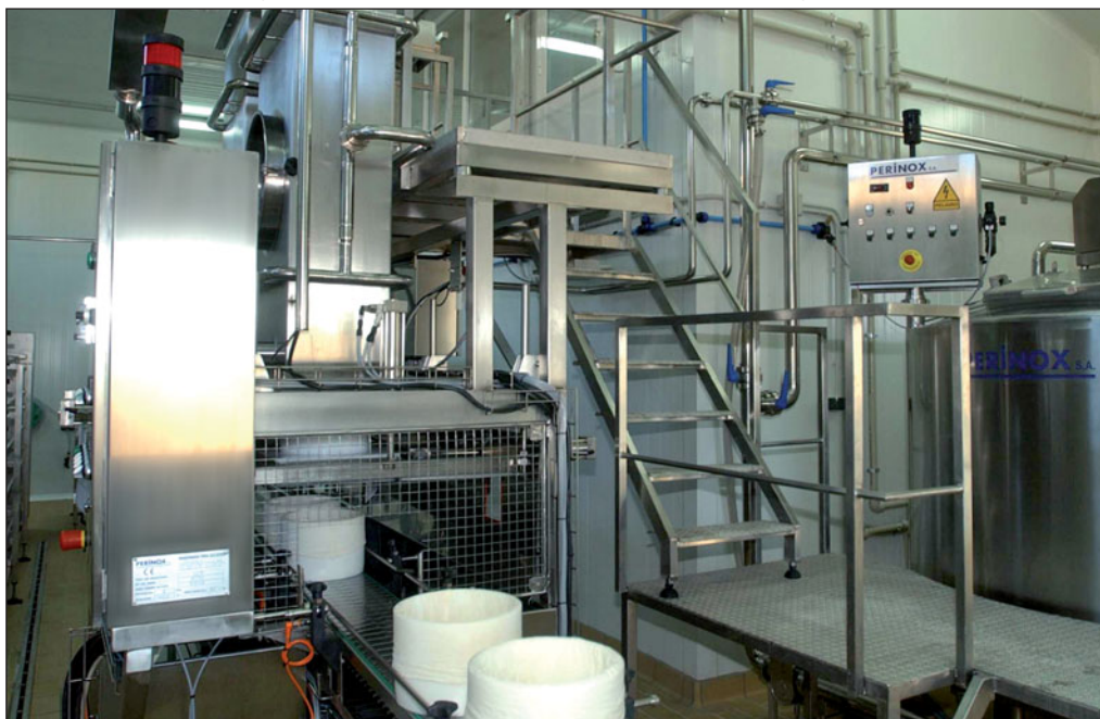
Durante el moldeado, la cuajada obtenida se introduce en moldes cilíndricos, en la imagen.
