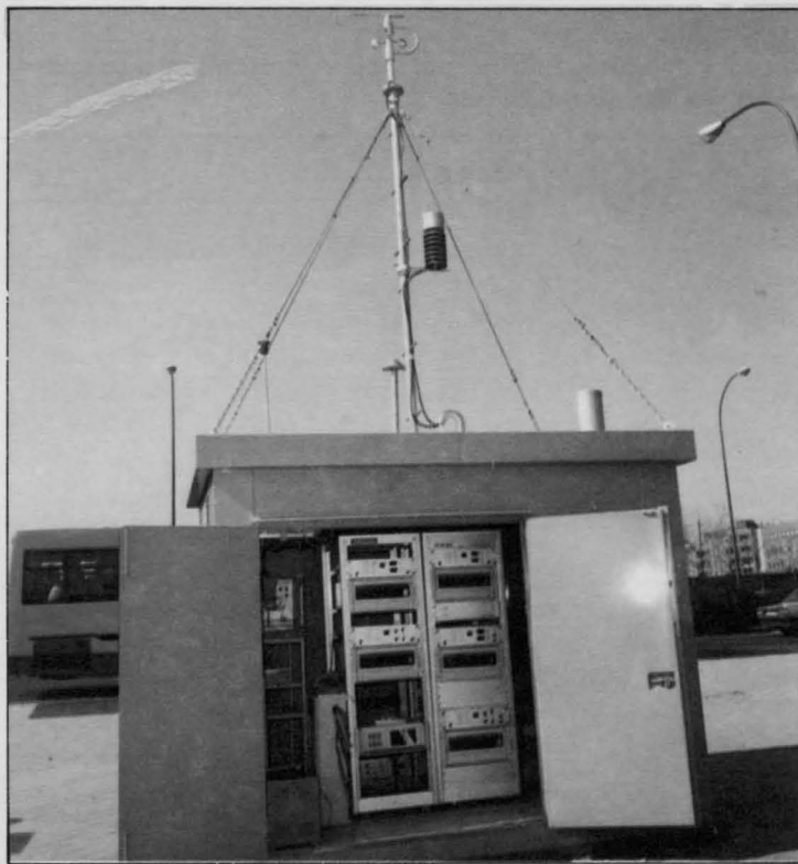
Las nuevas cabinas incorporarán siete sensores distintos que medirán cada 30 minutos la composición del aire.
