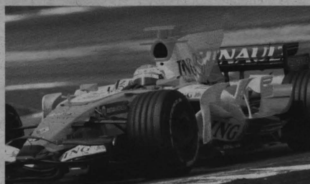
Alonso pilotó ayer el R28 con el nuevo alerón con forma de aleta de tiburón, entre otras innovaciones aerodinámicas.
