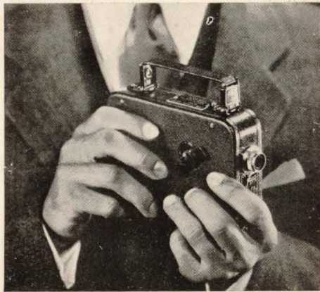
El visor directo va montado en el asa del aparato.
