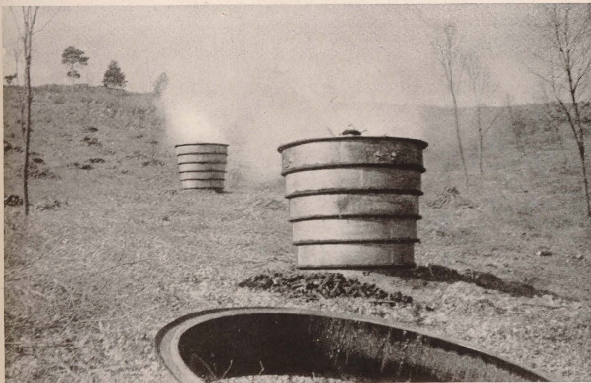
Vista de hornos metálicos autocarbonizadores.
