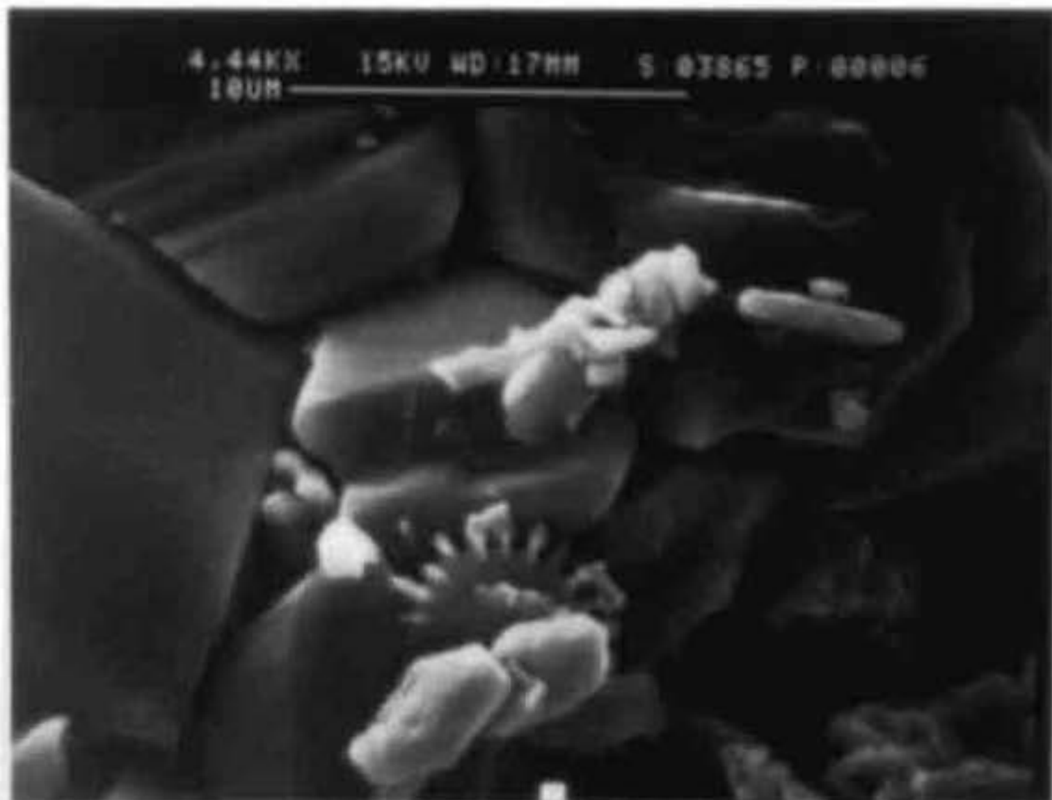
Fig. 43. Detalle de la fotografía anterior en la que se observa la frústula disuelta de diatomea. Imagen de Microscopía Electrónica de Barrido.
