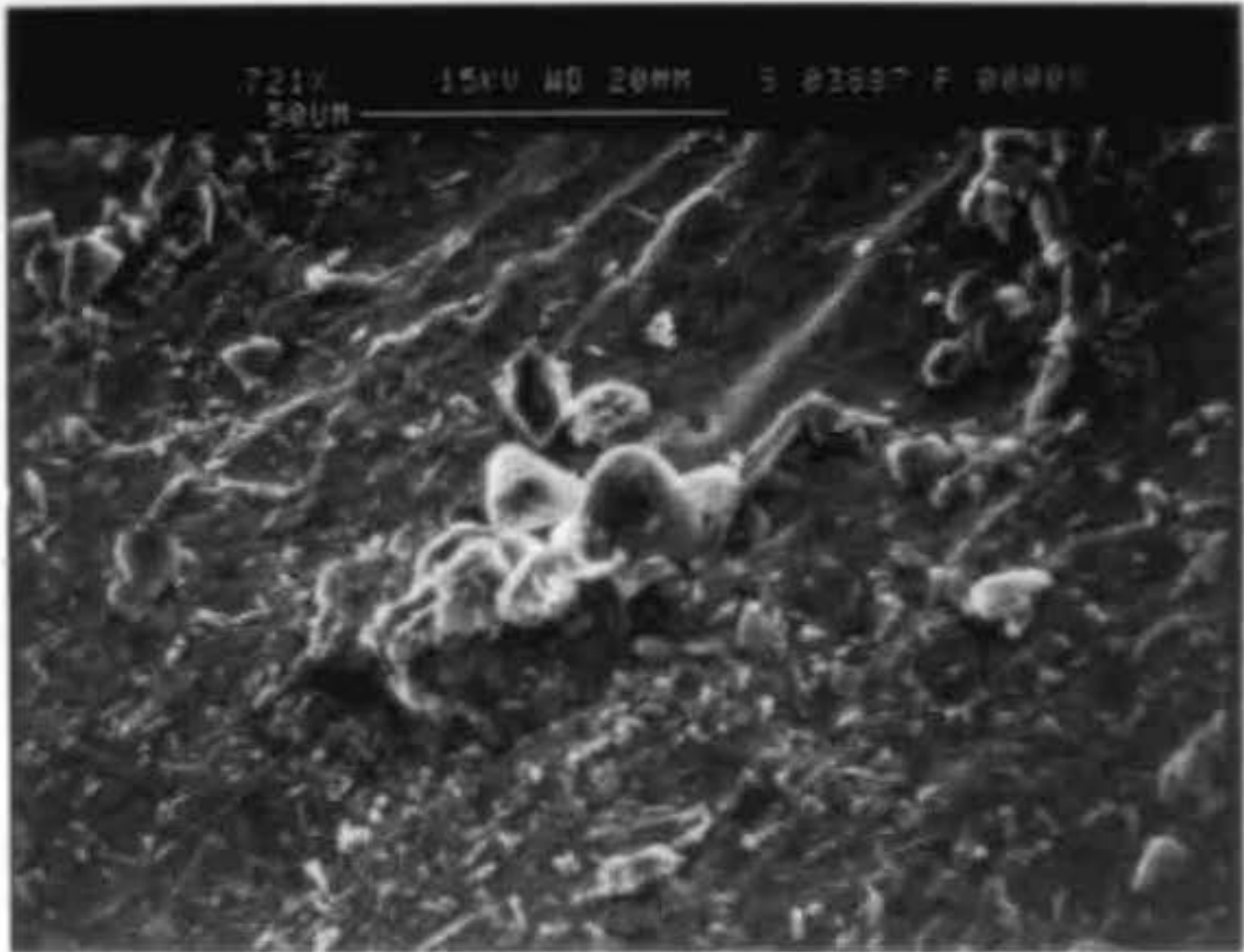
Fig. 46. Microestructura masiva de ópalo C. T con «silas» en las que se han preservado frústulas de diatomeas bien conservadas, Nódulo de sílex negro centimétrico, trozos de chert de la base de la cantera CEKESA. Imagen de Microscopía Electrónica de Barrido.
