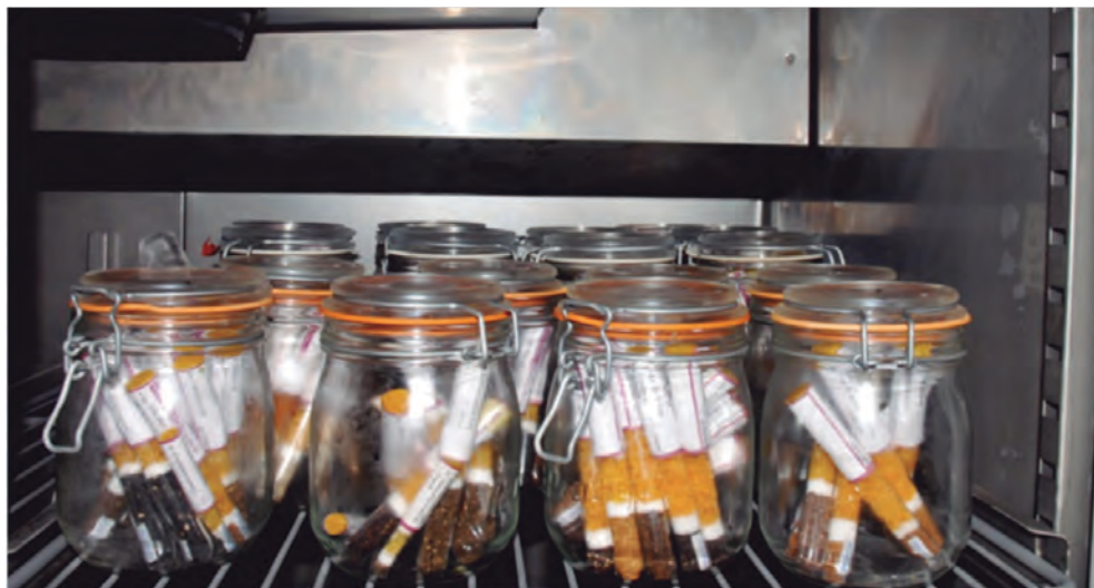
Figura 5. Jarras herméticas en el interior de la cámara de refrigeración ( -10^{\circ}\text{C} ) que albergan de forma hermética los tubos de vidrio, con las semillas y el gel de sílice indicador, previamente sellados a la llama.
