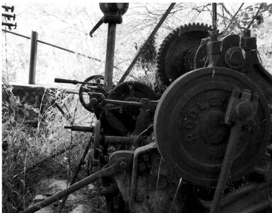
Maquinaria de la barcaza draga que permitía la extracción del lodo.
