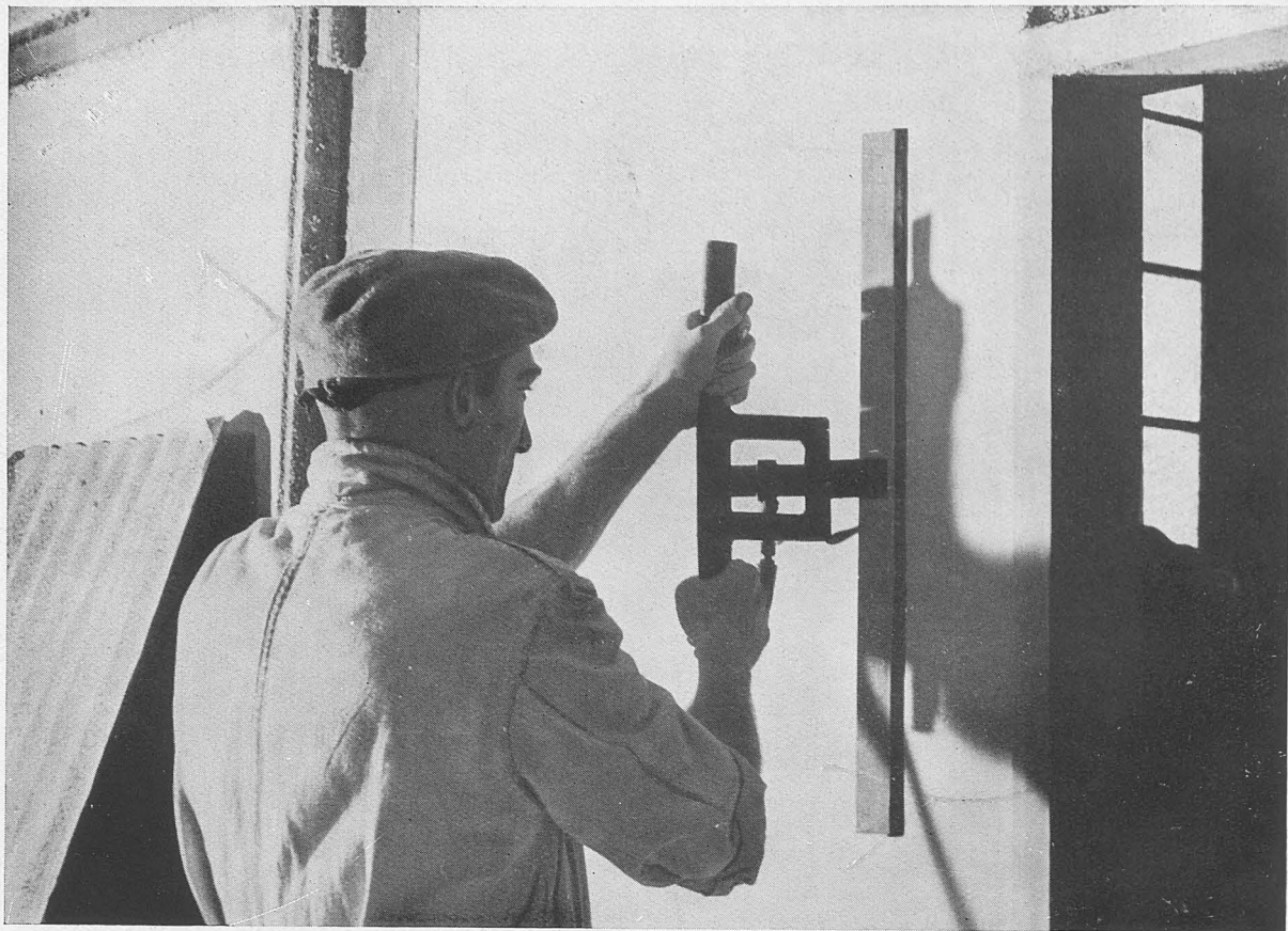
Pruebas de resistencia del nuevo producto "Pyrok".
