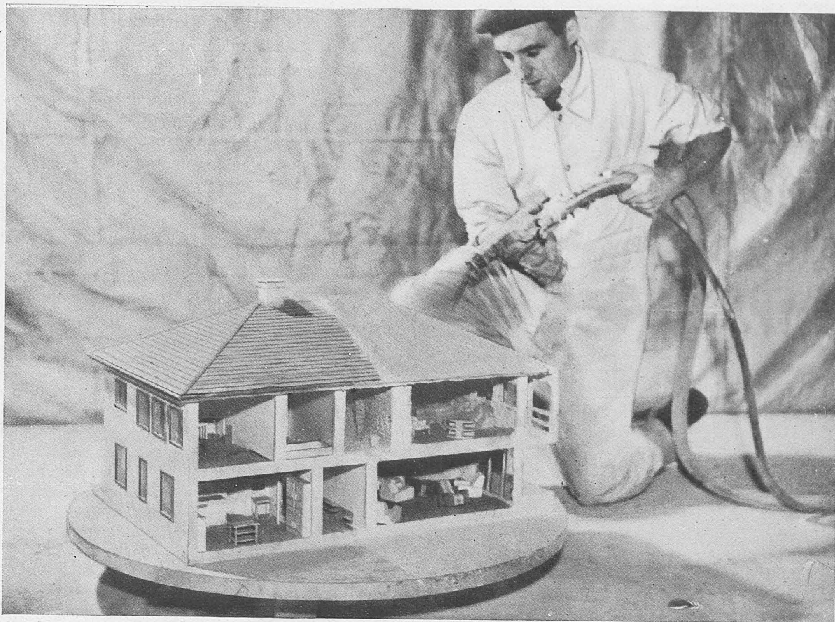
Prueba de incombustibilidad en una maqueta, cuya cubierta ha sido parcialmente revestida con "Pyrok".
