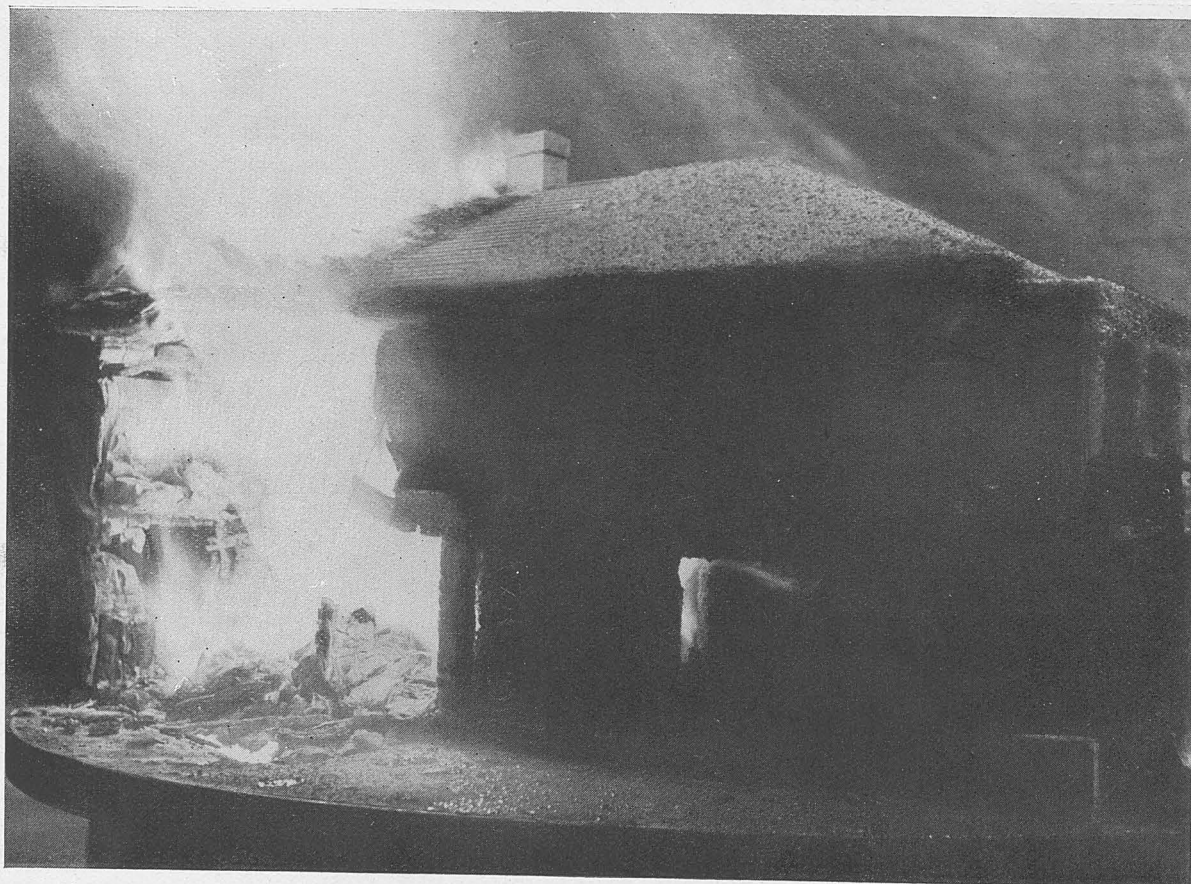
Prueba de incombustibilidad en una maqueta, cuya cubierta ha sido parcialmente revestida con "Pyrok".
