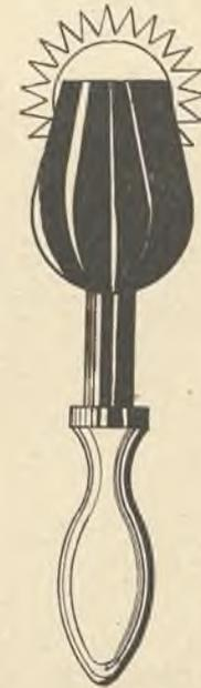
La espuela del apicultor tiene la ruedecilla con los dientes acanalados en su plano central, como indica el detalle del dibujo, para que el alambre, insertándose en esta hendidura, sirva de guía a la espuela al deslizarla para fijar el alambre en la cera. Como se emplea en caliente, su armadura de bronce es muy gruesa para conservar el calor.
