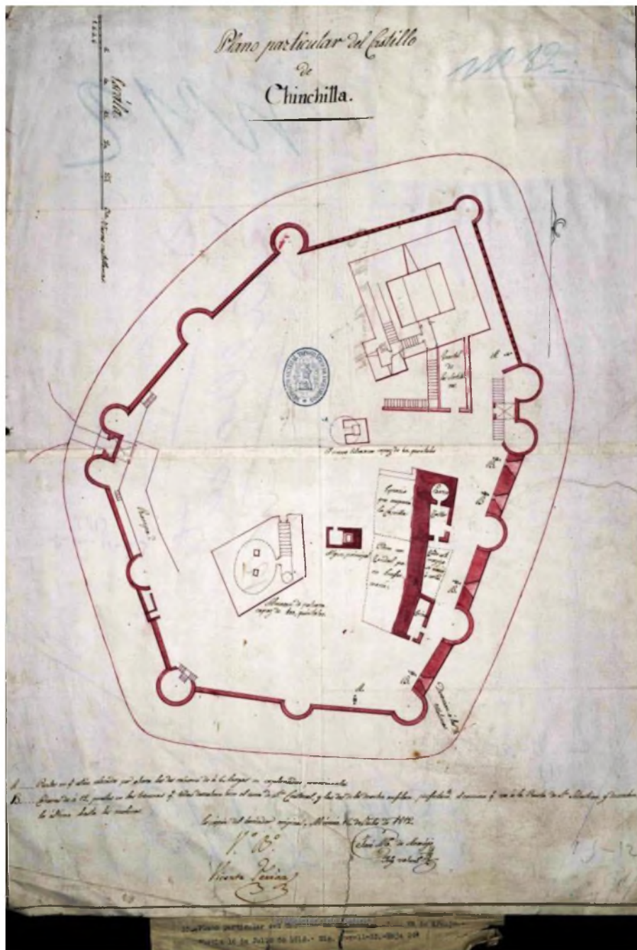
Figura 11.- Plano particular del castillo de Chinchilla en el que se indica la situación de la artillería con la que contaba la fortaleza: dos cañones de "a 6 largos" señalados con la letra A y cuatro cañones de "a 12 largos" señalados con la letra B. Copiado del original por el ingeniero José María de Araujo el 16 de julio de 1812. Centro Geográfico del Ejército. Sig. P-r-11-53. Hoja 24.
