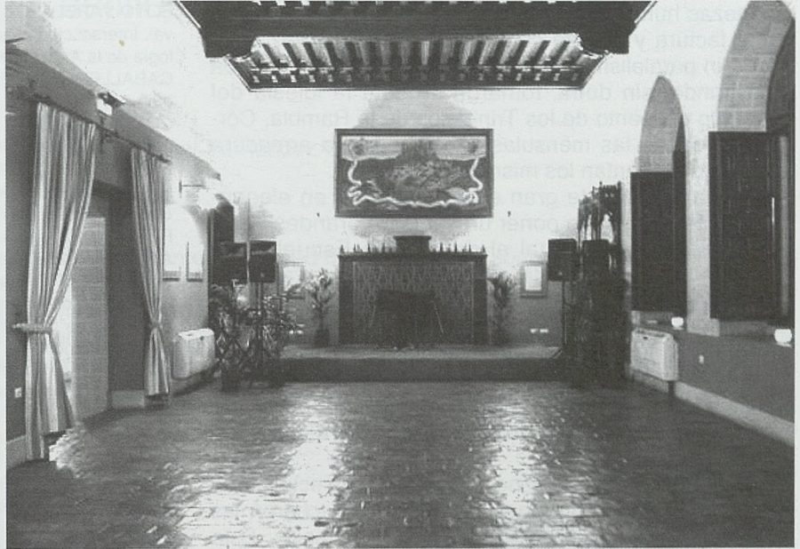
Es un amplio espacio diáfano de 12,5 m de largo, 7 m de ancho y 5 m de alto. Las vigas del techo son de madera de pino de tea. Tienen función exclusivamente decorativa ya que e techo de la Biblioteca posee –por expreso deseo de Torralva– una de las estructuras más resistentes del castillo
