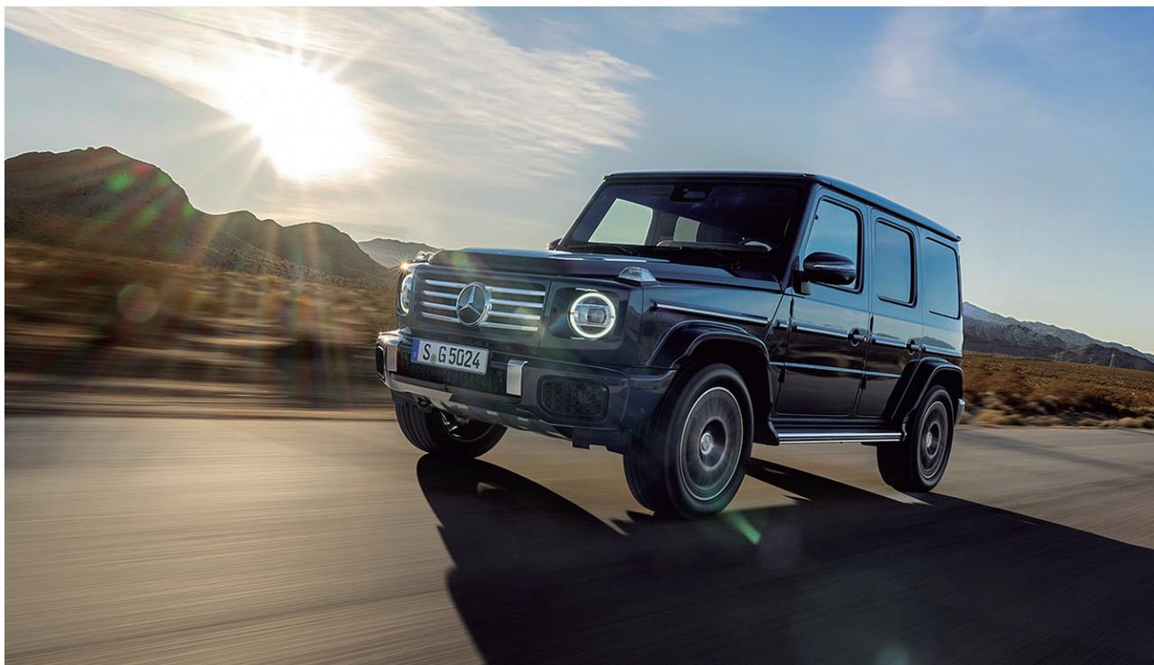
La nueva Clase G de Mercedes-Benz continúa la historia de éxitos de la serie de modelos creada en 1979. Este icono del todoterreno sigue apostando por una construcción de chasis de escalera de eficacia probada, tres bloqueos mecánicos de diferencial y reductora LOW RANGE, así como un eje trasero rígido y una suspensión delantera independiente.
