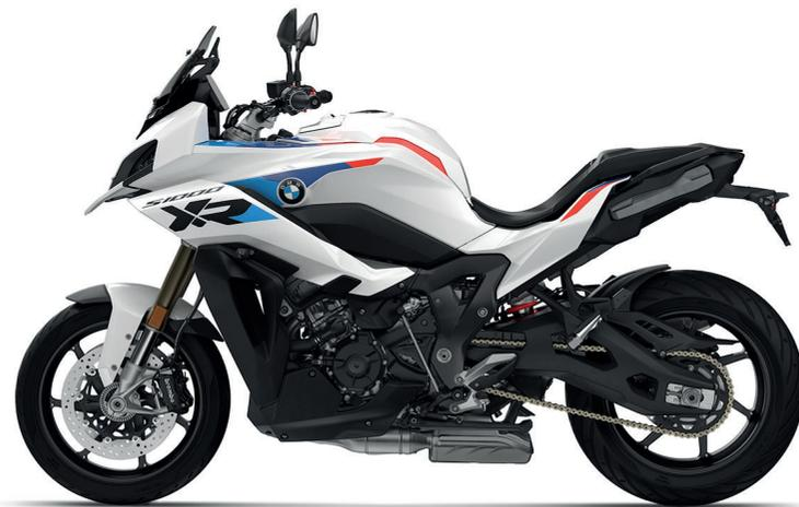
que contribuye a una excelente manejabilidad. En comparación con el modelo predecesor, la potencia del motor se ha incrementado en 4 kW (5 CV) para llegar ahora a 125 kW (170 CV) a un régimen nominal del motor sin cambios de 11.000 rpm. Las principales razones del aumento de rendimiento son una geometría optimizada del flujo de los canales de admisión
