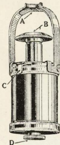
El Autodisparador Kodak se adapta a todos los Kodaks y a todos los aparatos con disparador de cable, y tiene por objeto permitir que el operador salga en la fotografía.
