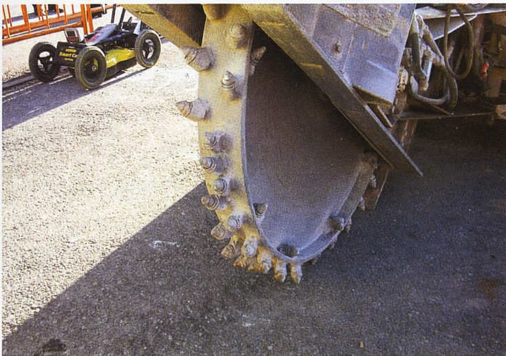
Marta Roldán, consejera de Ciencia y Tecnología era la encargada de poner la 'primera piedra' de la red de ONO. Abajo, la máquina que hará las zanjas por las que ONO meterá su fibra óptica.
