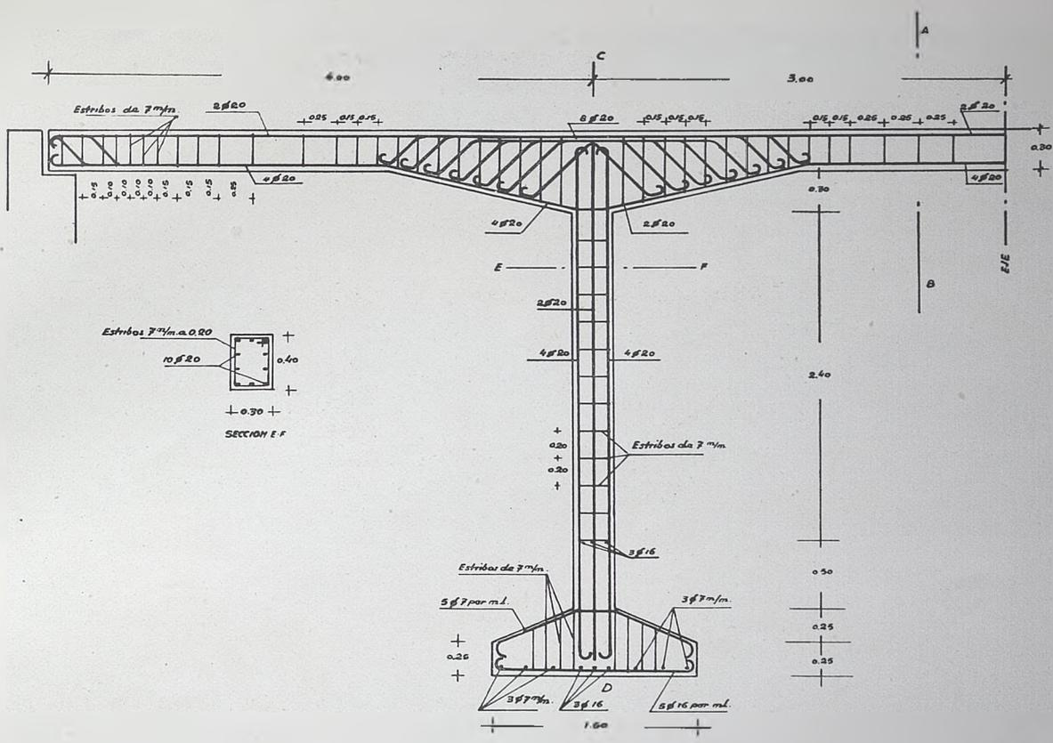
Puente sobre el encauzamiento del rio Sió. Semisección longitudinal. Abajo: Detalle del estribo y sección transversal.
