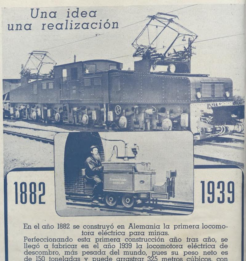
descombro, más pesada del mundo, pues su peso neto es de 150 toneladas y puede arrastrar 325 metros cúbicos, con un peso total de 1.000 toneladas. Su equipo eléctrico es de 6 motores con una potencia total de 2.000 HP.
