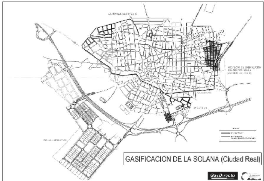
En color gris oscuro, se subrayan las zonas donde ya existe canalización de gas instalada y en condiciones de dar servicio. En color gris claro se muestran tramos donde hay red pero aún no se encuentra conectada al mallado principal.
