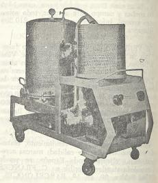
Filtros de placa construída en ACERO INOXIDA BLE. En un solo pase abrillanta los vinos pur embotellar con mínimo consumo de filtrolina Varios modelos, según rendimiento.
