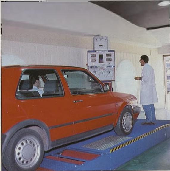
En sus modernas instalaciones dispone de toda la maquinaria y equipamiento oficial de la Inspección Técnica de Vehículos (I.T.V.): Frenometro, Banco de Amortiguación, Alineador de Ruedas, Reglaje de Luces, etc.
