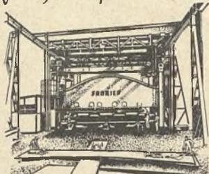
para curvar planchas de hierro para construcciones navales, fue construida por la casa FRORIEP / RHEIDT. Este coloso pesa 720.000 Kg. y con una presión del rodillo de 5.000 toneladas, es capaz de curvar en frío, completamente, planchas de 12.500 mm. de ancho y de 50 mm. de espesor.
