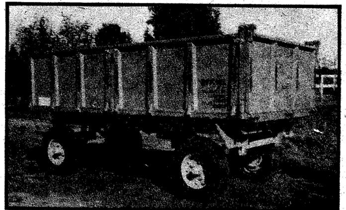
Remolques basculantes de dos ejes, reforzados.
