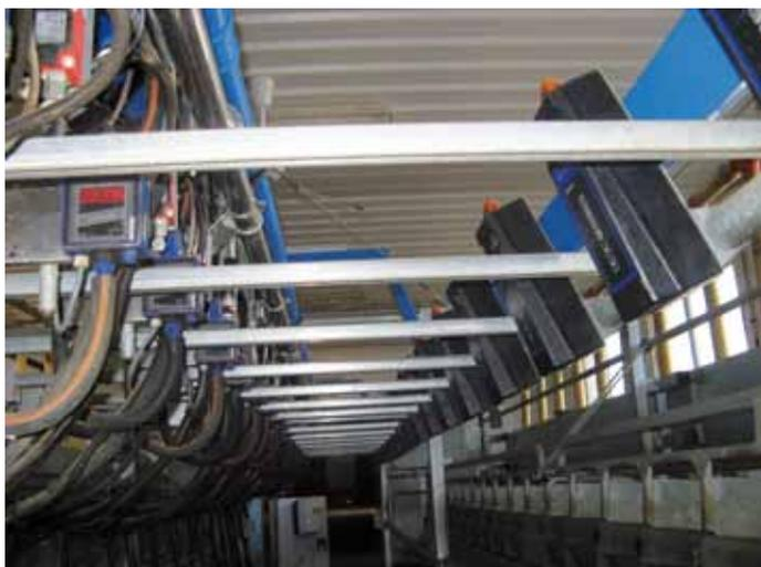
Los retiradores constan de un dispositivo de corte automático de vacío y un dispositivo que retira las pezoneras, aunque en pequeños rumiantes suele estar presente solo el primero de ellos.
