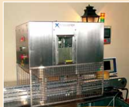
Equipo desarrollado durante el proyecto que permite controlar defectos en el interior de los quesos
