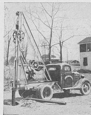
Perforadora pozos «Consol», para agua. Efectúa toda clase de perforaciones hondas y difíciles. El equipo se puede acoplar a un auto, por medio de un dispositivo especial. Pidan detalles.
