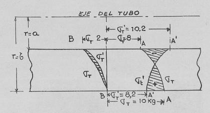
Si después de llevar el material del cilindro al estado plástico —dado que hemos rebasado su punto de fluencia— hacemos desaparecer la presión interna del tubo, y suponiendo que durante la descarga el material sigue la ley de Hooke, las fatigas que desaparecen vendrán dadas por las ecuaciones correspondientes al estado elástico con la presión  $P_{\rm p}$ , en vez de p, o sea:
