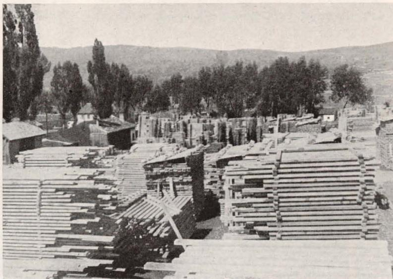
Trabajos de clasificación y encastillado de la madera aserrada para su desecación al aire libre.
