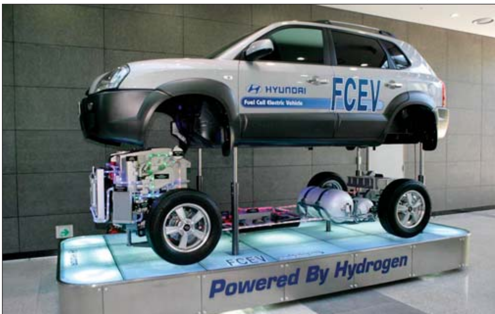
Los vehículos impulsados por pilas de combustible se pueden convertir en un medio para almacenar energía en forma de hidrógeno que, a su vez, se convertiría en electricidad. Foto: Prototipo de vehículo impulsado por hidrógeno.
