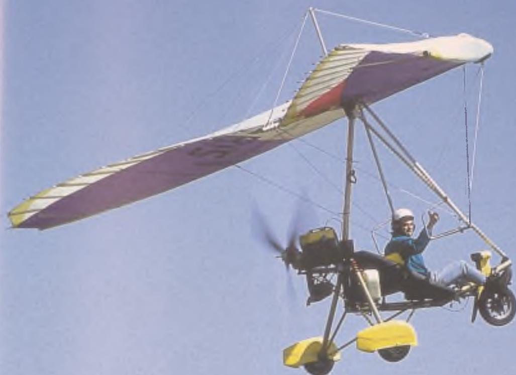
to de tela de alta resistencia, hace que este ULM disponga de una fabulosa superficie aerodinámica, dando lugar a la característica más sobresaliente de este avión: su extraordinario margen dinámico de velocidades. La comodidad de la cabina se aprecia fácilmente en la disposición de los mandos *flaps* y el agrupamiento de palancas de gases y frenos en el mismo centro, completándose con un generoso panel de instrumentos.
