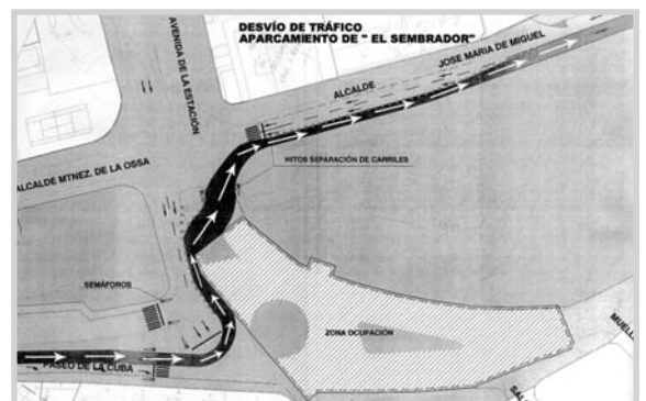
Desvíos del aparcamiento de El Sembrador.
