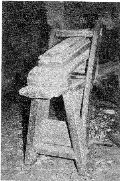
Terminadas de labrar se "rejuntan" las duelas, en el SEMÉN, que es una garlopa grande montada por sus extremos sobre unos pies firmes, en plano inclinado para facilitar el trabajo, cuya cuchilla entra por la cara inferior y tiene el filo hacia arriba. En él se moldean las duelas dándoles a los cantos la inclinación necesaria para el buen acoplamiento de unas con otras y el adelgazamiento preciso en los extremos para formar las testas. A esta garlopa suelen llamarle también LA PALOMA.
