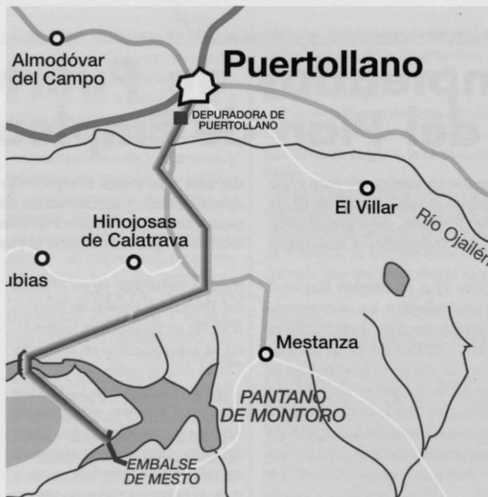
La tubería desde los embalses de Mesto y Cruces, según muestra el plano, tendrá una longitud de 15 Kms.
